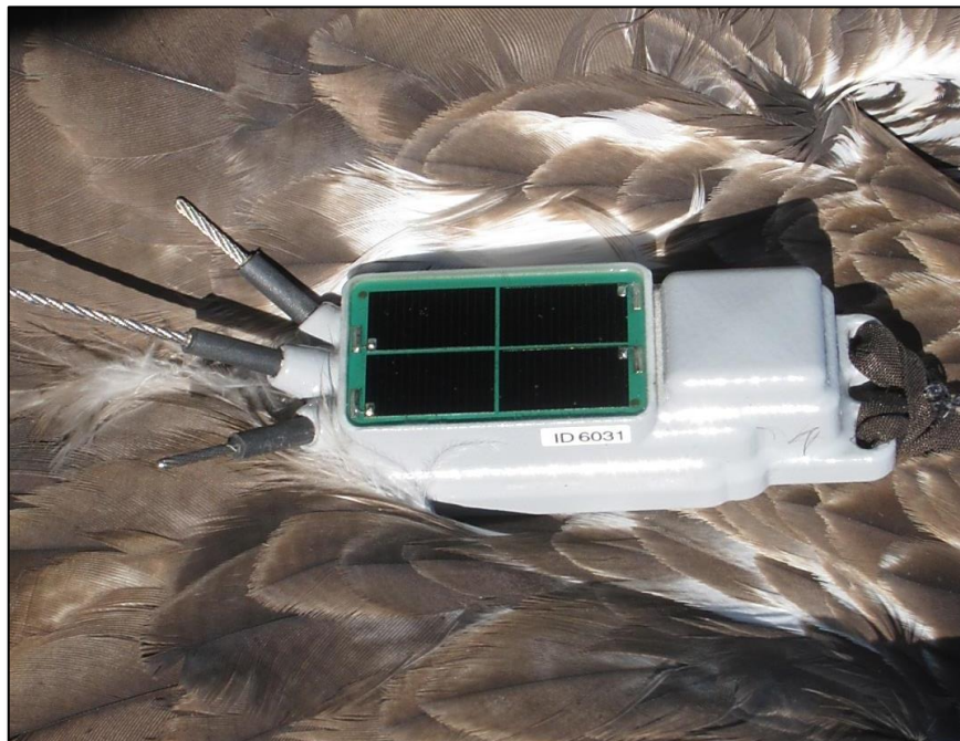
Fig. 6: Detalle del emisor E-obs GPS/solar GPRS utilizado en el radioseguimiento telemétrico de los pollos de Águila de Bonelli dentro del proyecto Aquila a-LIFE en Álava.
