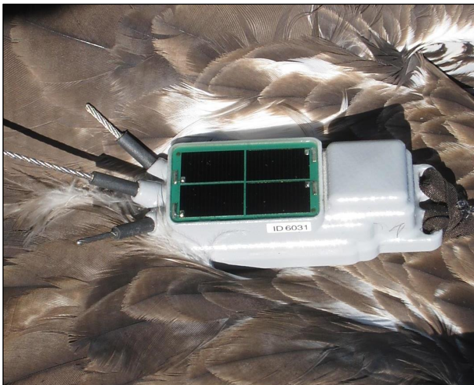
Fig. 6: Detalle del emisor E-obs GPS/solar GPRS utilizado en el radioseguimiento telemétrico de los pollos de Águila de Bonelli dentro del proyecto Aquila a-LIFE en Álava.
