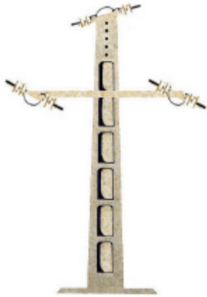
12A MONTAJE 1 AMARRE SUPERIOR Hormigón
