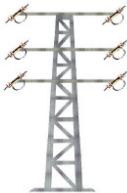
62 DOBLE CIRCUITO Metálico+amarre
