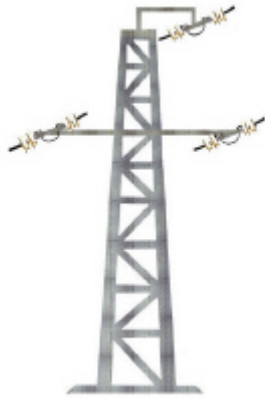
21A MONTAJE 1 AMARRE INFERIOR Metálico+farolillo
