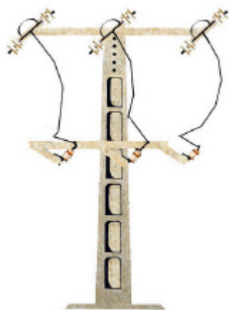
14D MONTAJE 0 AMARRE SUPERIOR Hormigón+seccionador
