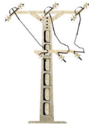
25B MONTAJE 0 AMARRE SUPERIOR Hormigón+derivación
