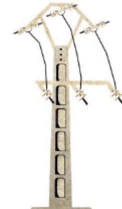
28E BÓVEDA Hormigón+amarre+seccionador
