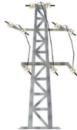
33D MONTAJE 1 AMARRE SUPERIOR Metálico+derivación
