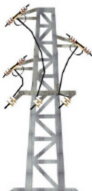
1R TRESBOLILLO Metálico+amarre+derivación
