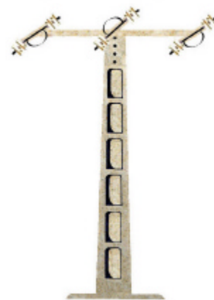
16A MONTAJE 0 AMARRE SUPERIOR Hormigón
