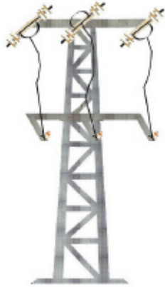
37A MONTAJE 0 AMARRE SUPERIOR Metálico+seccionador
