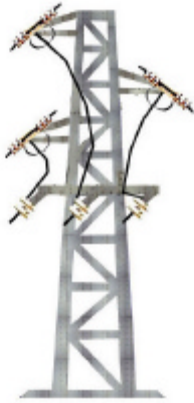
1M TRESBOLILLO Metálico+amarre+seccionador
