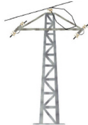
19B MONTAJE 1 AMARRE INFERIOR Metálico
