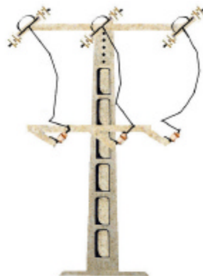
26A MONTAJE 0 AMARRE SUPERIOR Hormigón+seccionador
