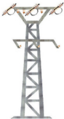
42F MONTAJE 0 AMARRE INFERIOR Metálico+seccionador+autoválvulas
