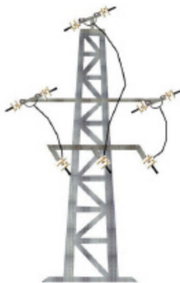
19C MONTAJE 1 AMARRE INFERIOR Metálico+derivación+seccionador
