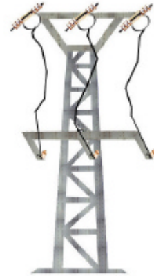
42B MONTAJE 0 AMARRE INFERIOR Metálico+seccionador
