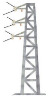
45F BANDERA Metálico+amarre+seccionador
