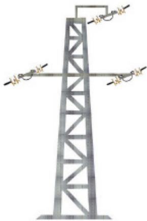
22D MONTAJE 1 AMARRE INFERIOR Metálico+farolillo
