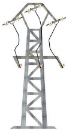
28B BÓVEDA Metálico+amarre+seccionador
