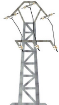
28C BÓVEDA Metálico+amarre+derivación+seccionador
