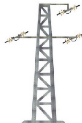
7D MONTAJE 1 AMARRE INFERIOR Metálico
