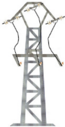
28F BÓVEDA Metálico+amarre+seccionador
