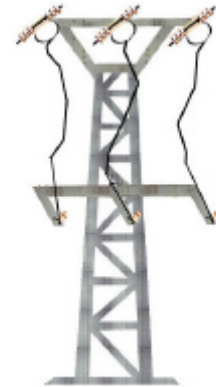
37B MONTAJE 0 AMARRE INFERIOR Metálico+seccionador
