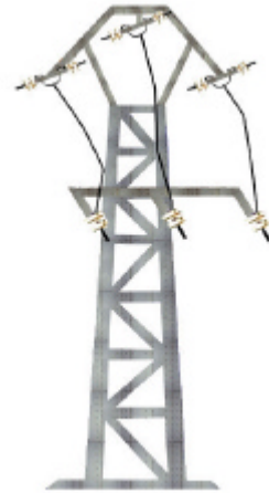
28A BÓVEDA Metálico+amarre+derivación
