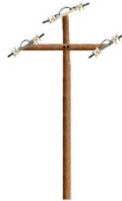
12B MONTAJE 1 AMARRE SUPERIOR Madera
