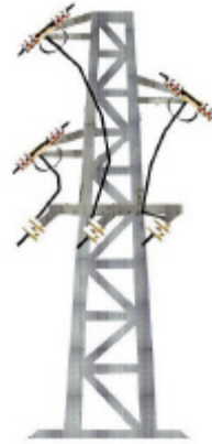
1N TRESBOLILLO Metálico+amarre+derivación+seccionador
