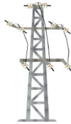
58 MONTAJE 1 AMARRE SUPERIOR Metálico+seccionador
