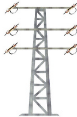
41C DOBLE CIRCUITO Metálico+amarre
