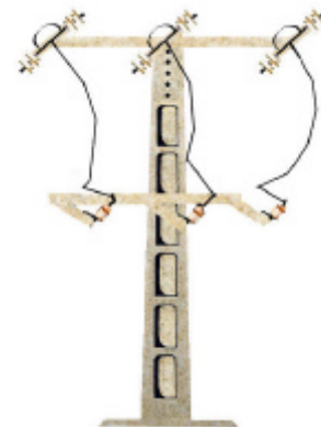
26B MONTAJE 0 AMARRE SUPERIOR Hormigón+derivación+seccionador
