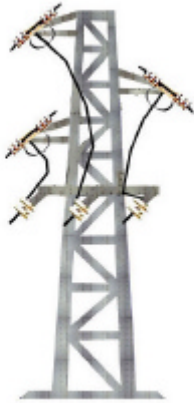
1P TRESBOLILLO Metálico+amarre+derivación
